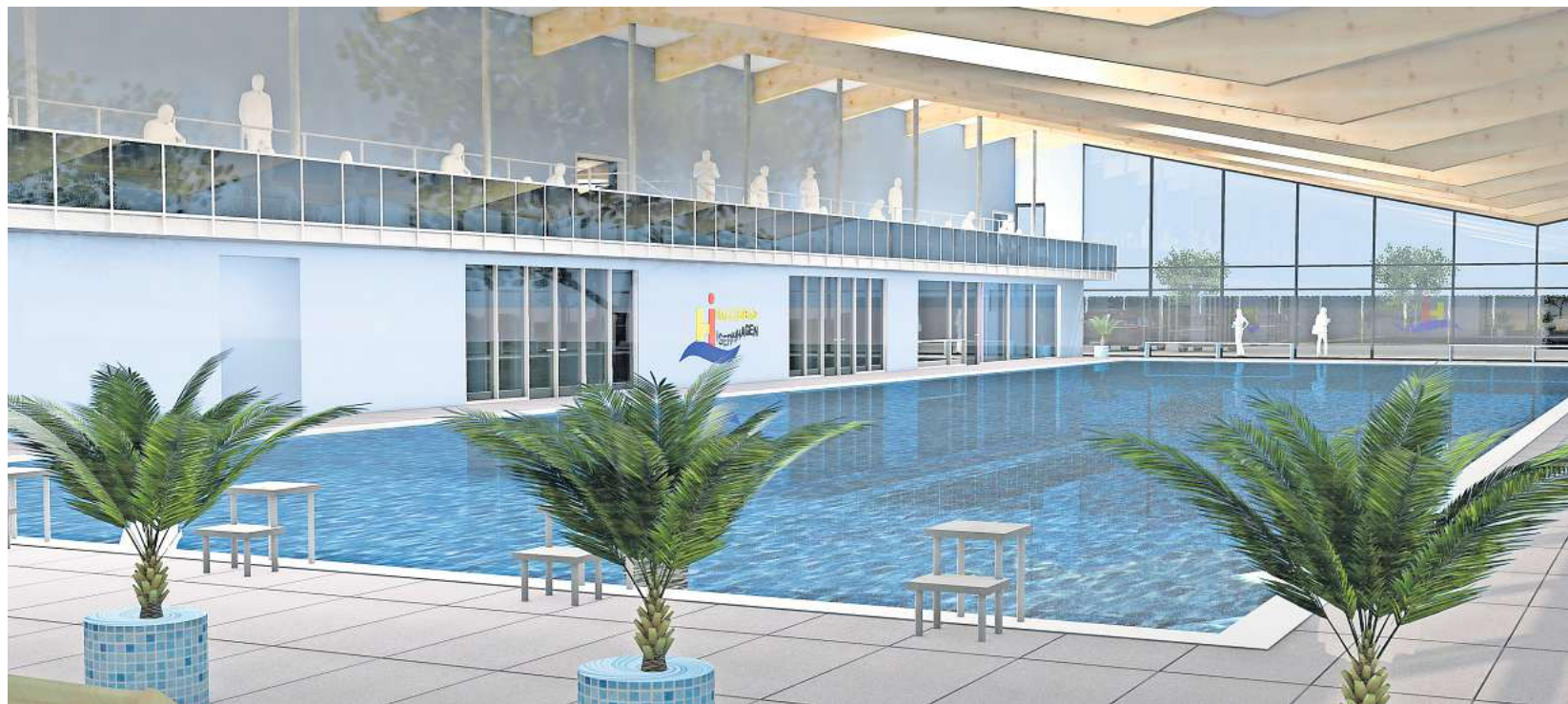
So könnte der Innenbereich des neuen Schwimmbads aussehen: Ein 50-Meter-Becken mit sechs Bahnen, das durch eine Trennwand in zwei 25-Meter-Bereiche aufgeteilt werden kann, hölzerne Deckenpaneelen in Wellenform und eine Tribüne für Zuschauer bei Wettbewerben.
